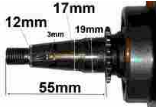
Abbildung 17: 6V Kurzer Polradzapfen
